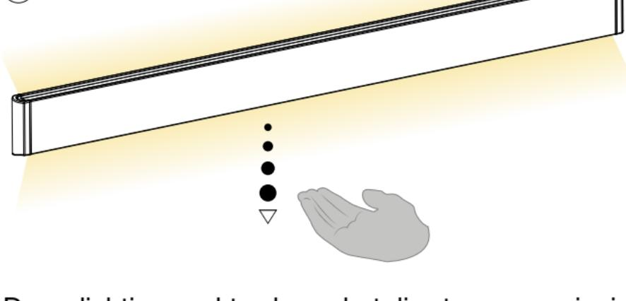
De verlichting werkt volgens het dim-to-warm principe. Bij feller licht geeft de lamp een koele, functionele kleurtemperatuur (tot 4000K). Wanneer het licht wordt gedimd, verschuift de kleurtemperatuur naar een warme, sfeervolle gloed (tot 2700K). Dit zorgt voor een natuurlijke overgang en altijd de juiste sfeer.
