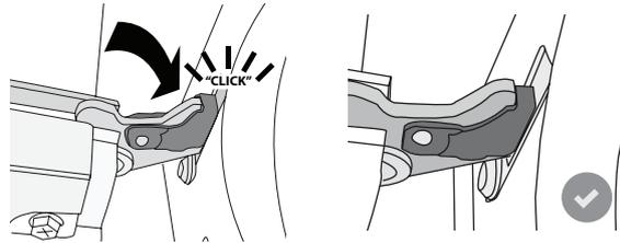
**5.** Probeer de deur te sluiten en controleer of het in lijn met het bedieningspaneel is. Als dit niet het geval is herhaalt u de bovenstaande stappen: als het niet goed werkt kan de deur beschadigd raken.
