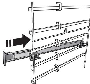
Verwijder de roostergeleiders uit de oven en verwijder het beschermende plastic van de schuifrails. Om de schuifrails aan te brengen, bevestigt u de bovenste klem van de rail aan de roostergeleider en schuift deze zo ver mogelijk door. Duw de andere klem naar beneden op zijn plaats.
