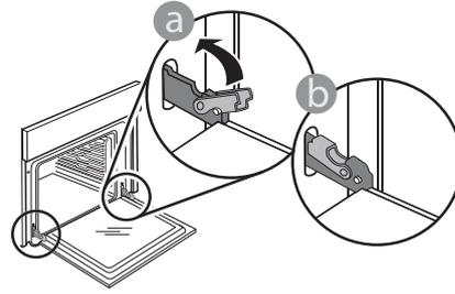
Einen leichten Druck ausüben, um zu überprüfen, dass sich die Haken in der korrekten Position befinden.
