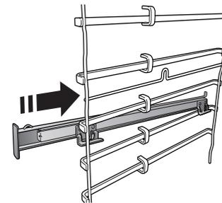
Die Seitengitter aus dem Ofen nehmen und den Kunststoffschutz von den Backauszügen entfernen.
