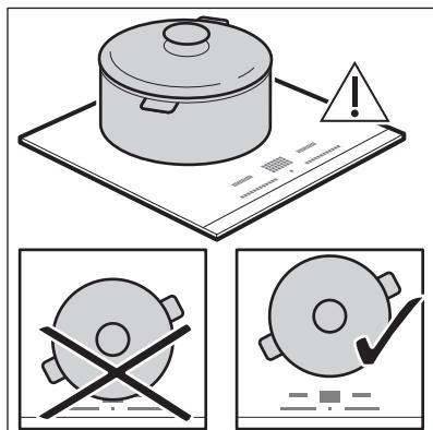
Posez le récipient au centre de la zone de cuisson souhaitée. Les zones de cuisson à induction s'adaptent automatiquement au diamètre du fond du récipient utilisé.
