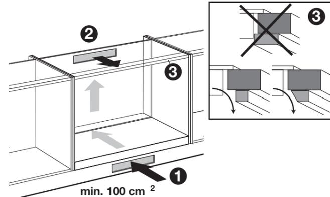
Als er een lade onder de kookplaat zit, is het is noodzakelijk om een houten inzetstuk, bevestigd met schroeven, op een minimale afstand van 50 mm van de onderkant van de kookplaat te plaatsen.
