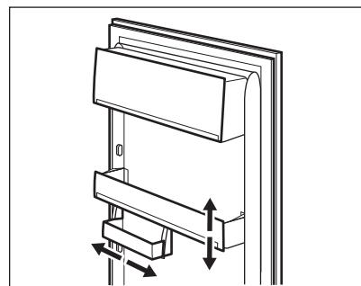
Dieses Modell ist mit einer variablen Lagerbox ausgestattet, die seitlich bewegt werden kann.
