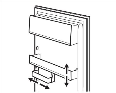
Ce modèle est équipé d'un compartiment de rangement variable qui peut être déplacé latéralement.
