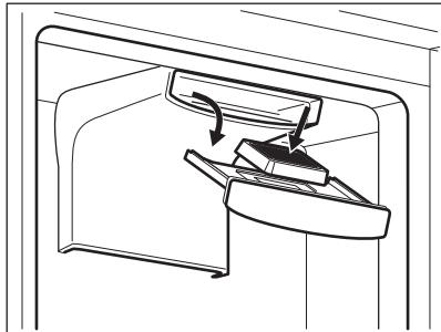
3. Setzen Sie den neuen Luftfilter in den Schlitz ein.
