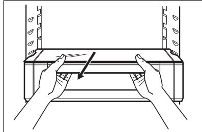
2. Kantel de module naar beneden om deze uit de koelkast te verwijderen.
