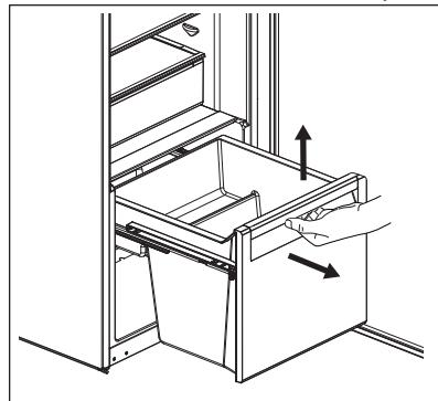
2. Duw de rails in de kast om schade aan het apparaat te voorkomen bij het sluiten van de deur.
