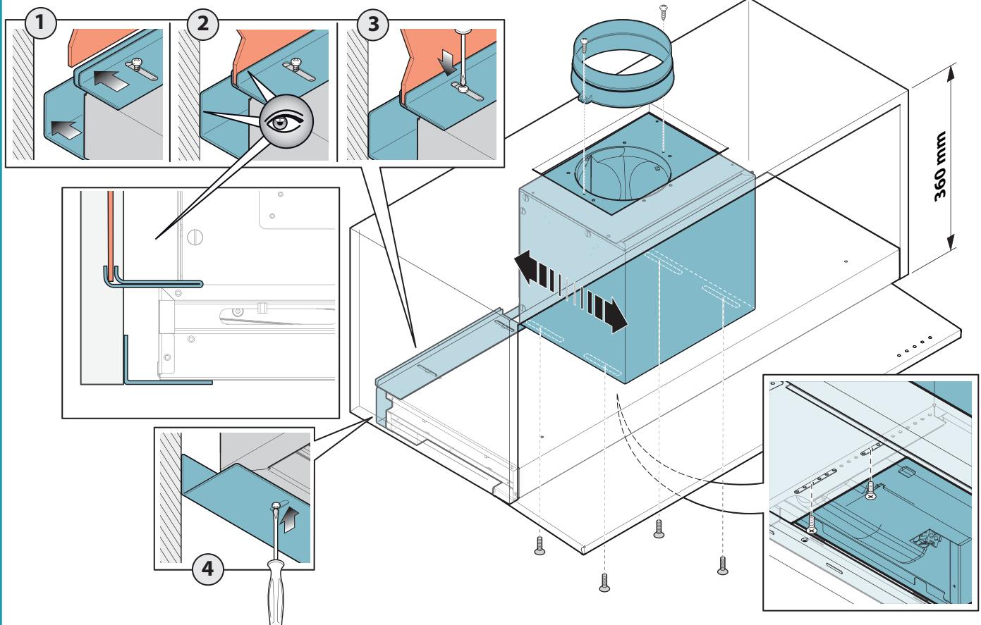
IT - Installazione con uscita verticale: Installazione valvola di non ritorno (6), tubo di aspirazione e collegamento elettrico (7)
