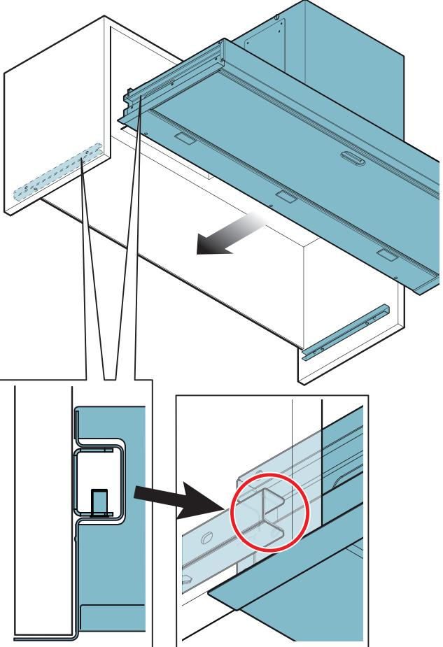
IT - Fissaggio cappa al pensile (4) centraggio camera motore e inserimento staffe posteriori (5).
