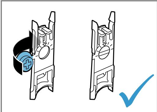
La fente de la vis d'ajustage doit d'abord être horizontale.
