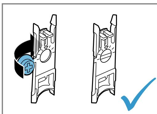
De sleuf van de stelschroef moet eerst horizontaal zijn.
