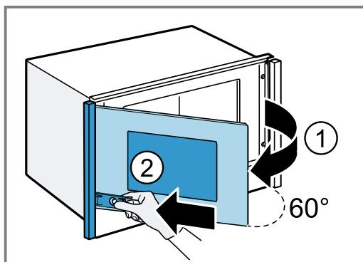
2. Um die Blende zu lösen, die Gerätetür schließen **①** und dabei das Befestigungselement an die Gerätetür und Richtung Blende drücken **②**.
