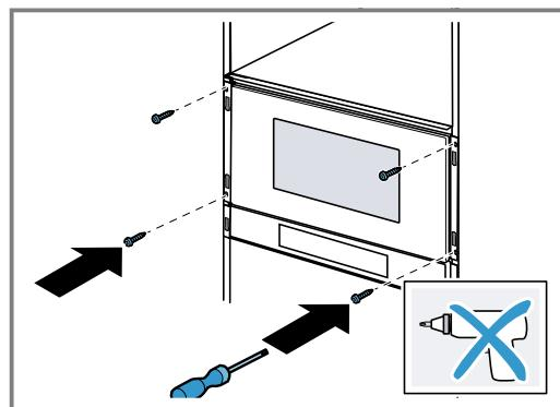
4. Rabattez les vis de réglage des éléments de fixation.
