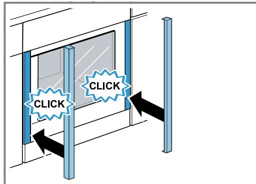
La rainure sur les bandeaux doit se trouver en haut. Positionnez la rainure dans les bandeaux sur la nervure transversale correspondante de la pièce de fixation rouge.
