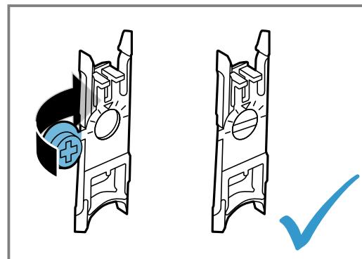
Der Schlitz der Einstellschrauben muss zunächst waagerecht sein.
