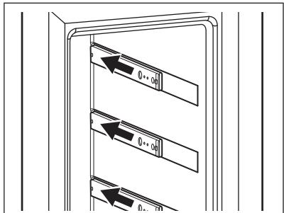
2. Setzen Sie die Ablage diagonal zum Gerät ein.
