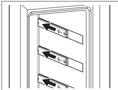
2. Breng de plank schuin in het apparaat.
