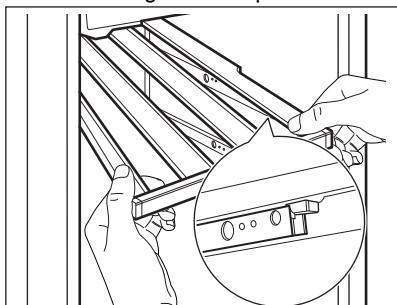
4. Druk de plank stevig omlaag om beide haken op de rails te vergrendelen.
