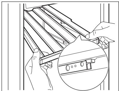
4. Drücken Sie die Ablage fest nach unten, um beide Haken an den Schienen einzuhaken.
