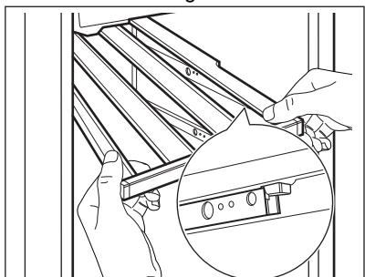
4. Appuyez fermement sur la clayette pour verrouiller les deux crochets sur les rails.
