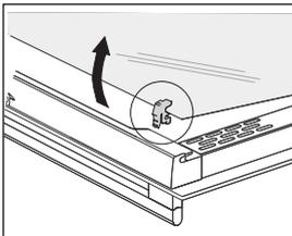
**3** Entfernen Sie die innere, dritte Glasscheibe (nur bei einigen Modellen), indem Sie die Glasscheibe leicht anheben und sie herausziehen. Entfernen Sie auch den Gummi von der Glasscheibe.
