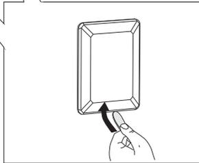
**1** Avec un tournevis plat, soulevez le couvercle de l'ampoule et enlevez-le.
