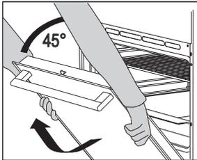
**3** Schließen Sie langsam die Gerätetür bis zum Winkel 45° (hinsichtlich der geschlossenen Position der Tür), heben Sie sie leicht an und ziehen Sie sie in Ihrer Richtung heraus.
