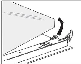
**2** Pak het glas vast aan de onderrand en til het voorzichtig omhoog om het uit de steun te verwijderen.
