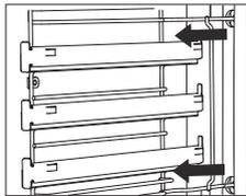
**2** Nehmen Sie die Führungen aus den Bohrungen der Rückwand heraus.
