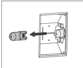
**2** Retirez l'ampoule halogène et remplacez-la par une neuve.
