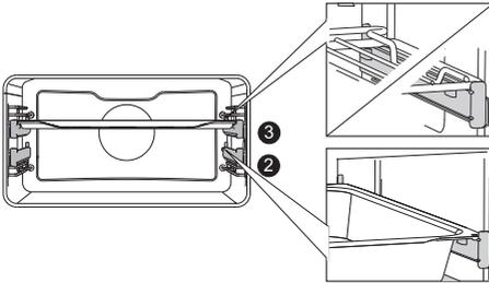
Ziehen Sie bei der Ausstattung mit Teleskopausziehführungen zuerst die Führungen einer Einschubebene heraus, stellen Sie den Rost oder ein Backblech darauf und schieben Sie sie wieder in den Garraum.
