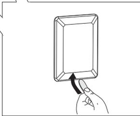
**1** Heben Sie die Abdeckung der Leuchte mit einem Schraubenzieher an und entfernen Sie sie.
