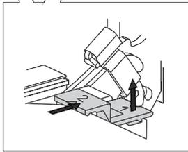
**1** Soulevez légèrement les supports situés sur les côtés droit et gauche de la porte (repère 1 sur le support) et retirez-les de la vitre (repère 2 sur le support).
