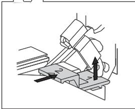
**1** Til de beugels aan de linker- en rechterkant van de deur een beetje op (markering 1 op de beugel) en trek deze iets van het glas af (markering 2 op de beugel).
