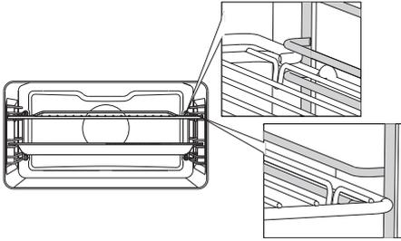
Wenn das Gerät Drahtführungen besitzt, müssen Sie den Rost und die Backbleche immer in die Führungsrinne der Drahtführungen einschieben.
