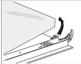
**2** Fassen Sie die Glasscheibe am unteren Rand an, heben Sie sie leicht an, damit sie aus dem Träger herauspringt und nehmen Sie sie heraus.
