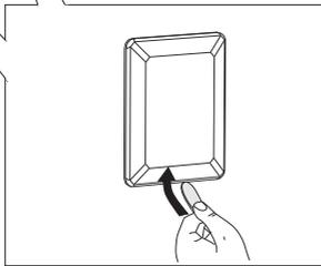
**1** Gebruik een platte schroevendraaier om het afdekplaatje van de lamp los te maken en verwijder het.
