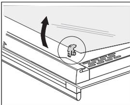
**3** Het binnenste derde glas (afhankelijk van het model) kan worden verwijderd door het voorzichtig op te tillen en te verwijderen. Verwijder ook de rubber afdichtingen rond het glas.
