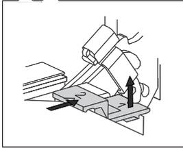
**1** Heben Sie die Träger auf der linken und rechten Seite der Gerätetür leicht an (Markierung 1 auf dem Träger) und ziehen Sie sie dann von der Glasscheibe weg (Markierung 2 auf dem Träger).
