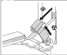
**2** Heben Sie die abnehmbaren Riegel leicht an und ziehen Sie diese in Ihrer Richtung.
