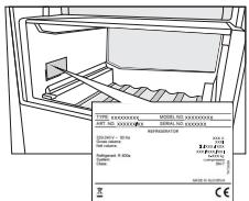
Het typeplaatje bevindt zich aan de binnenzijde van het apparaat (zie afbeelding). Op dit plaatje staat informatie over spanning, bruto- en netto-inhoud, type en hoeveelheid koelmiddel, en informatie over de klimaatklasse.
