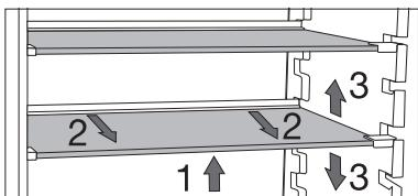
De draagplateaus zijn gemaakt van veiligheidsglas. Wanneer u de hoogte van een plateau wilt wijzigen, tilt u deze eerst aan de voorzijde op (1). Houd de achterzijde vast en trek het plateau iets naar voren (2). Verplaats het plateau omhoog of omlaag (3).
