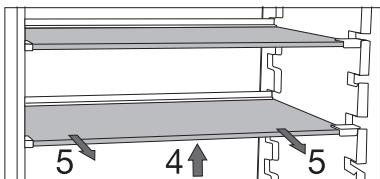
Wanneer u het plateau uit de koelkast wilt verwijderen, tilt u deze eerst aan de voorzijde op (4). Houd de achterzijde vast en trek het plateau geheel uit het toestel (5).
