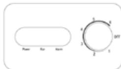
Wenn die Umgebungstemperatur steigt, stellen Sie das Gerät auf eine höhere Einstellung ein, um die Innentemperatur zu gewährleisten.
